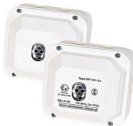
Infrarot Melder sind gut geeignet für Objekte, in denen man keine Rauchmelder einsetzen will, weil schon die normalen Arbeitsabläufe starken Rauch entwickeln. Ultraviolett-Melder werden bevorzugt in Bereichen eingesetzt, in denen mit Bränden ohne Rauchentwicklung gerechnet werden muss. Häufige Anwendung in der chem. Industrie zur Überwachung von Anlagen zur Verarbeitung oder Lagerung von brennbaren Flüssigkeiten.
